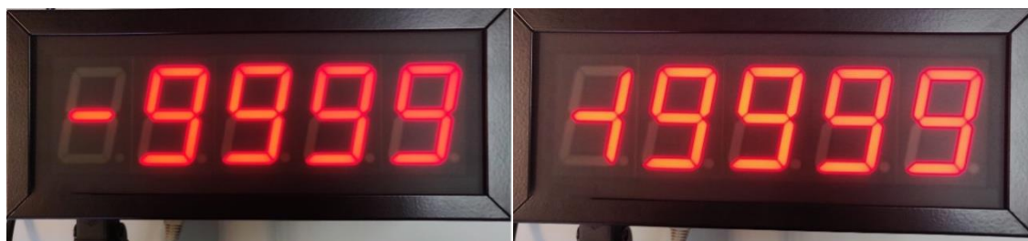
Fig. 16: A la izquierda, valor mínimo en "FULL DIGIT", -9999. A la derecha, valor mínimo en "HALF DIGIT", -19999.
