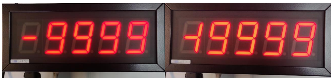
Fig. 55: A gauche, valeur minimale en "FULL DIGIT", -9999. A droite, valeur minimale en "HALF DIGIT", -19999.
